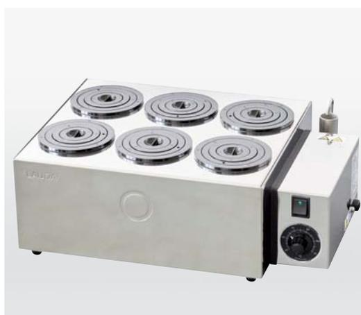
H 11 V con carcasa exterior de acero inoxidable, especial para trabajos en campanas extractoras
